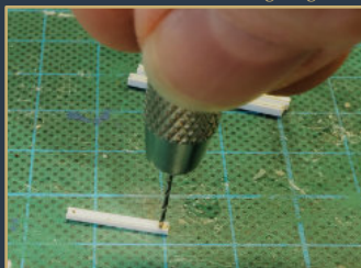
Löcher bohren für Schrauben und die Welle.
