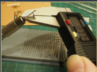
Bohrlöcher Ho 0,8mm, Spur 0 1,0 mm
