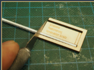
Die beiden IPB-Profile werden abgelängt.
