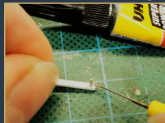
Mit flüssigem Sekundenkleber fixiert.
