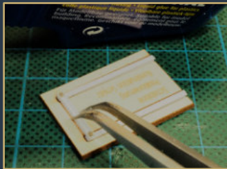
Der Querträger wird auf die Stützen geklebt.
