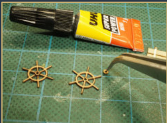
Handrad mit Buchse versehen.
