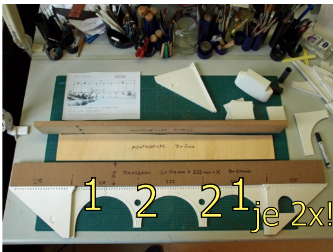
V1240 Grundset (Teile für Steinseiten): 1 - 2 Paar Stirnteile „Zwickel“, 4 Stck. Stirnteile „Schlüpfer“ Bauseits: 1 MDF-Streifen in Brückenlänge 84mm breit (möglichst dick, hier 19mm), ein zweiter MDF-Streifen 84mm breit als Montagehilfe, ein 6mm Streifen als Montagehilfe (z. Bsp. Sperrholz)
