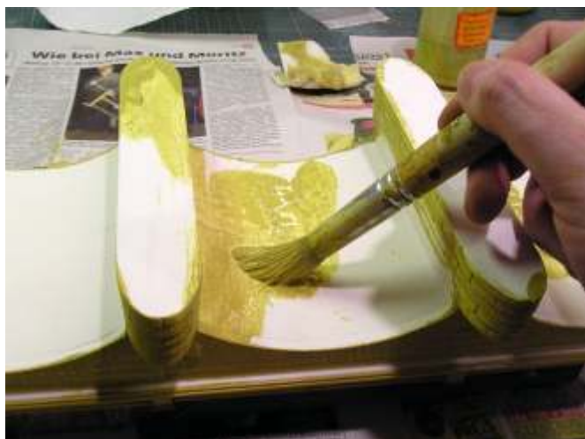
Zuerst wird das Modell grundiert. Wir haben hier stark verdünnte Künstleracrylfarbe in einem gelblichen Sandsteinton benutzt. Hobby-Acrylfarben sind aber genauso geeignet. Die Grundierung sperrt die Saugfähigkeit des Gipses etwas ab. Um die Brücke auf den Rücken zu legen, wird zum Bsp. ein Waggonkarton zwischen die Brüstungen gelegt.
