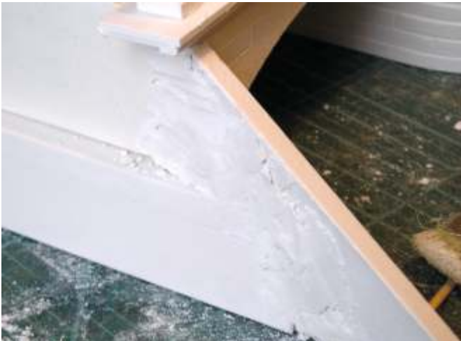
Die Klebeverbindungen der Flügelwände sind ziemlich empfindlich. Darum ist es sinnvoll die Rückseiten dick mit aufgetragenen Gips zu verstärken. Dazu kann ruhig normaler Baumarktgips verwendet werden.
