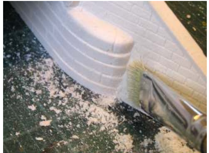
Etwas knifflig ist die Montage der Flügelwände, die auf den Vorköpfen der Widerlager aufliegen. Evtl. ist hier etwas Schleifarbeit notwendig und die Spalten müssen verspachtelt werden. Die Wirkung, der wie beim Vorbild eingebauten Flügelwände ist sehr gut.. Wenn der Brückenanschluß aber nicht über einen Bahndamm gehen soll, muß aus Bauplatten (z. Bsp. ETERNO V1450 u. V1451) je nach Geländesituation ein Brückenkopf gebastelt werden.
