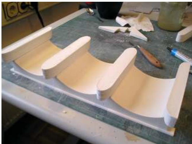
Um die Pfeiler aufzukleben, sollte das Modell auf dem Rücken liegen. An den Seiten werden für die Widerlager die halbierten Pfeiler aufgeklebt, in der Mitte die "Eisbrecher". Auf korrekte Zentrierung achten!
