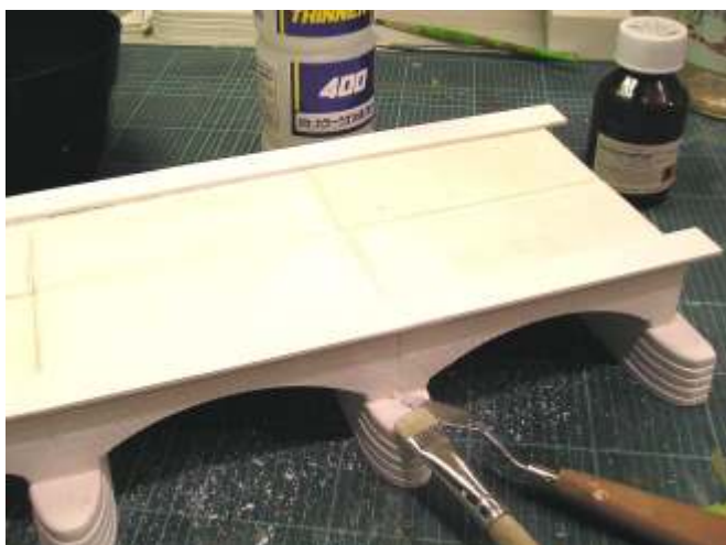
Auch die Fugen an den Vorköpfen werden Verspachtelt. Die Abdeckungsplatten (die seitlich etwas auskragen) werden aufgeklebt (als Erste die Mittlere), die Stöße verspachtelt und verschliffen.
