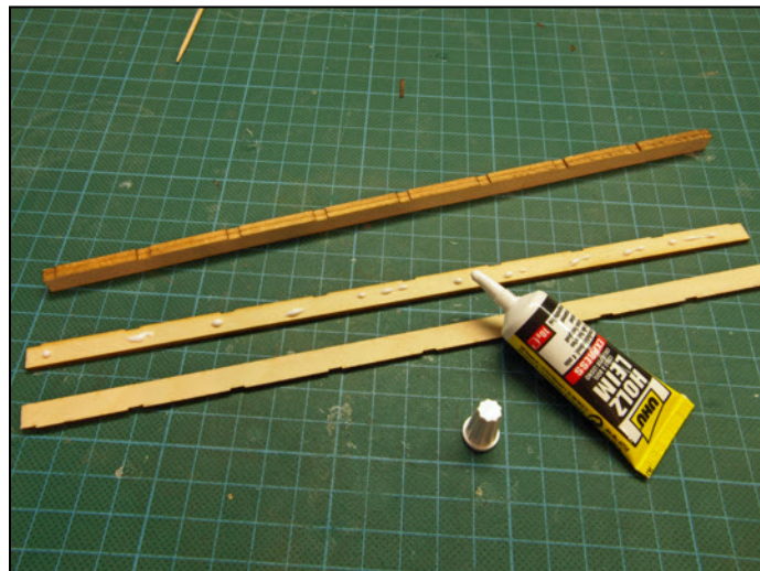
Für die Bauanleitung wurde zum großen Teil die Spur 0-Version verwendet. Der Zusammenbau ist aber identisch. Als erster Bauschritt werden die beiden Längsträger aufgedoppelt. Der ideale Klebstoff für den Bausatz ist Holzleim.
