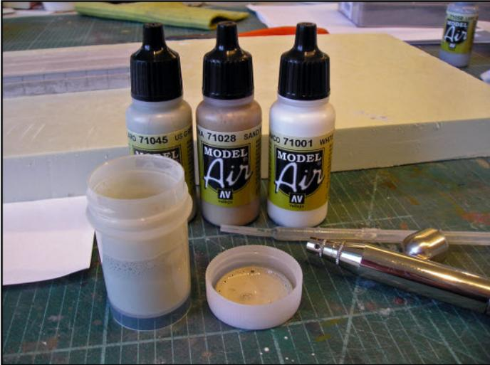
Für die Farbgebung der Trittkanten haben wir Vallejo Modellbauacrylfarben und den Airbrush (den Triplex von Gabbert) benutzt. Die Model Air-Farben sind bereits spritzfertig und mit den Tropffläschen einfach, praktisch und sauber zu dosieren. Die Betonfarbe der Kanten wurde aus MA 001 weiß mit etwas MA 045 US-hellgrau und einem Tröpfchen MA 028 sandgelb gemischt.
