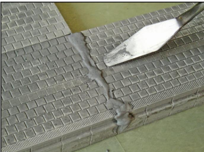
Der Spachtelgips wird nicht zu dick, sämig angerührt, so daß er in die Fugen laufen kann. Dem Gips wird schnell die Feuchtigkeit entzogen.
