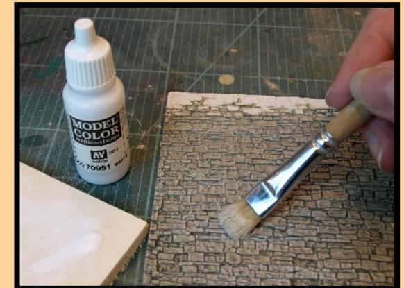
*Beim Trockenmalen werden durch Überwischen mit dem ausgestrichen Pinsel an den Erhöhungen „Lichter“ gesetzt. Die Plastizität der Oberflächen wird dadurch betont. Bei unserem Beispiel mit weißer MC und einem flachem Borstenpinsel.*
