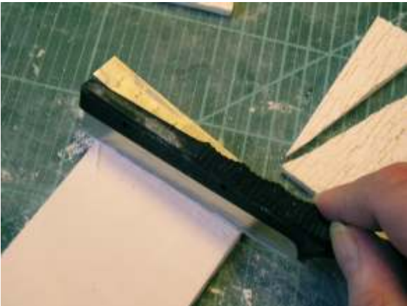
Wenn nötig werden die Bauteile zum Ablängen mit einem feinem Sägeblatt ohne Druck gesägt.
