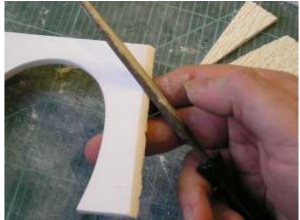
Für Außenecken müssen die Kanten mit einer Feile auf etwas weniger als 45° abgeschrägt werden.
