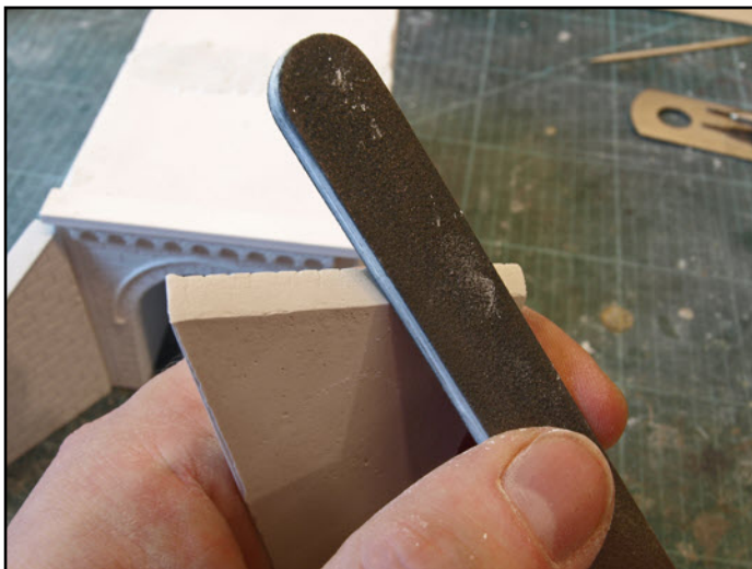
Mit einer Schleife werden die Flügelwandteile entgratet.
