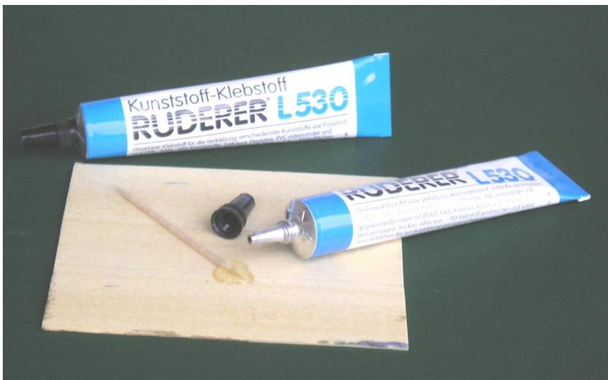
Dieser, vor allem in der Industrie verwendete Klebstoff, ist ursprünglich als Klebelack gedacht, um verschiedene Kunststoffe (PS, ABS, PVC, PET, Acryl, Celluloid, SAN, SB, PMMA etc.) miteinander und mit anderen Materialien wie Metall, Keramik, Glas, Holz, Textil, Pappe... zu verkleben. Dazu ist er vorzüglich geeignet. Aber auch unsere Spezialgipsbauteile können damit problemlos, sehr
