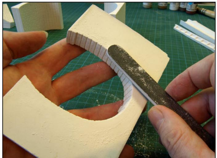
Zu erst werden die einzelnen Bauteile vorbereitet, hier werden die Gießgrate abgeschliffen, Einschusslöcher werden geschlossen etc.. Hinweise dazu gibt unserer `Bauen mit Gips´-Blatt.
